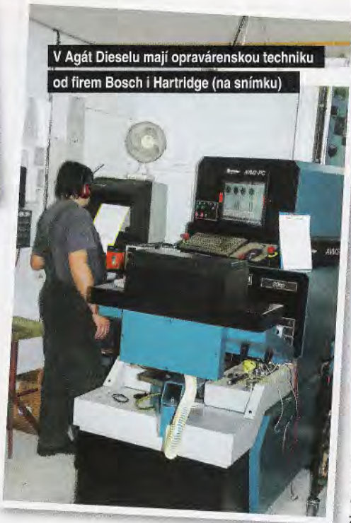
Mechanik při montáži vstřikovačů Bosch na zkušební stanici
